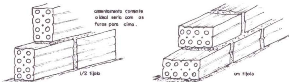
Figura 1 - Execução de alvenaria utilizando tijolos furados.
