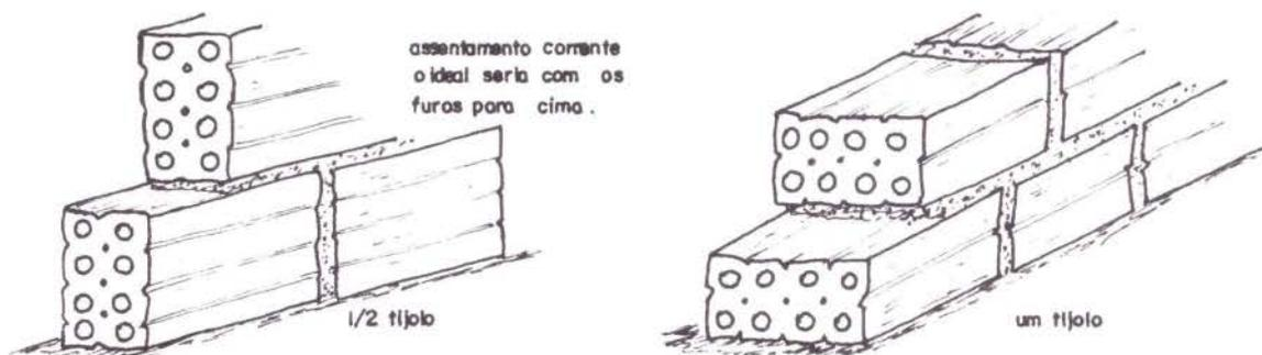
**Figura 1 - Execução de alvenaria utilizando tijolos furados.**
