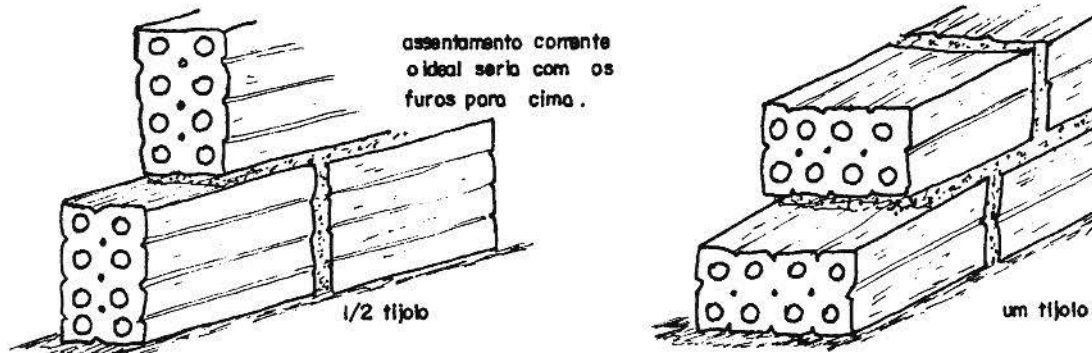
Figura 1 - Execução de alvenaria utilizando tijolos furados.
