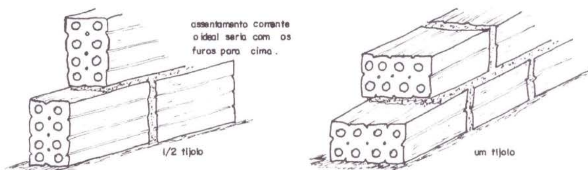
Figura 1 - Execução de alvenaria utilizando tijolos furados.
