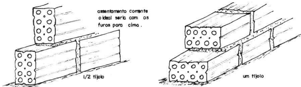
Figura 1 - Execução de alvenaria utilizando tijolos furados.
