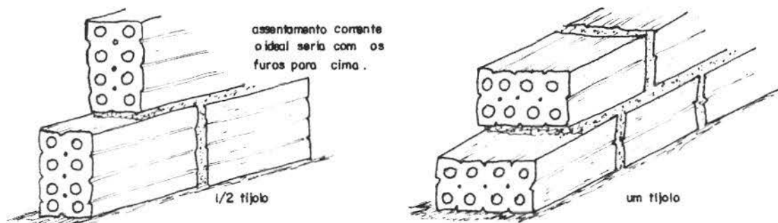
Figura 1 - Execução de alvenaria utilizando tijolos furados.
