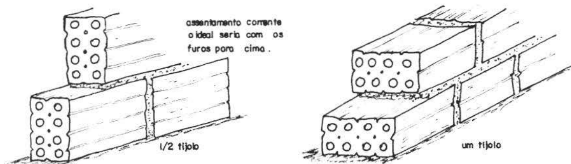
Figura 1 - Execução de alvenaria utilizando tijolos furados.
