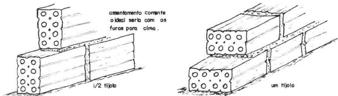
Figura 1 - Execução de alvenaria utilizando tijolos furados.
