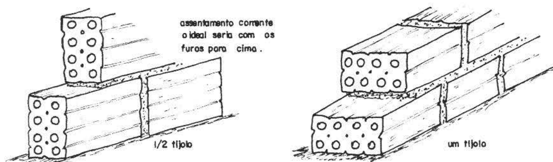
Figura 1 - Execução de alvenaria utilizando tijolos furados.
