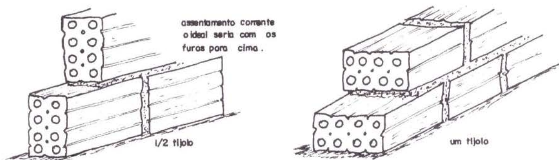
Figura 1 - Execução de alvenaria utilizando tijolos furados.
